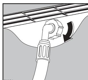
Подключите наливной шланг к водопроводному крану с резьбой 3/4".
