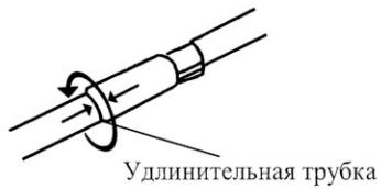
Соедините обе трубы – как показано на рисунке (для модели T-2344PS). Для телескопических трубок (модель T-2345TS) – нажмите пластиковую кнопку и вытяните на необходимую длину внутреннюю трубку. Убрать трубку внутрь следует также при нажатой пластиковой кнопке.
