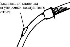
Силу всасывания пылесоса можно также менять с помощью клавиши на ручке шланга, изменяя мощность воздушного потока.
