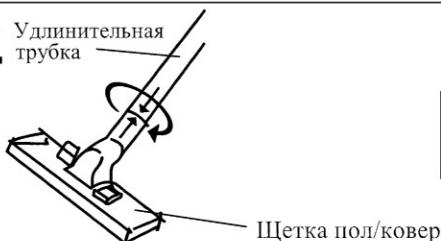
Подсоедините к удлинительной трубке щетку пол/ковер или другую насадку.
