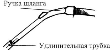
Подсоедините ручку шланга к удлинительной трубке, подкрутив ее с небольшим усилием.
