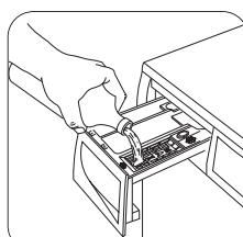
Вытяните до упора дозатор моющих средств. Отмерьте нужное количество моющего средства, засыпьте его в отделение основной стирки дозатора **1**, и, если Вы желаете выполнить предварительную стирку или вымачивание, засыпьте его в отделение, помеченное символом **2**.
